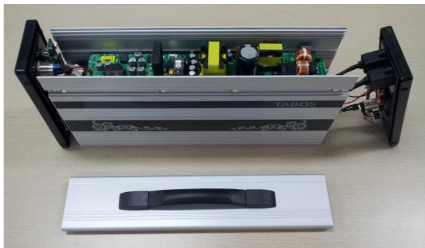
내부 구조 ( 충전기 + 배터리 + 전압조정기 + 종합관리장치 )
