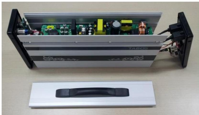
내부 구조 ( 충전기 + 배터리 + 전압조정기 + 종합관리장치 )
