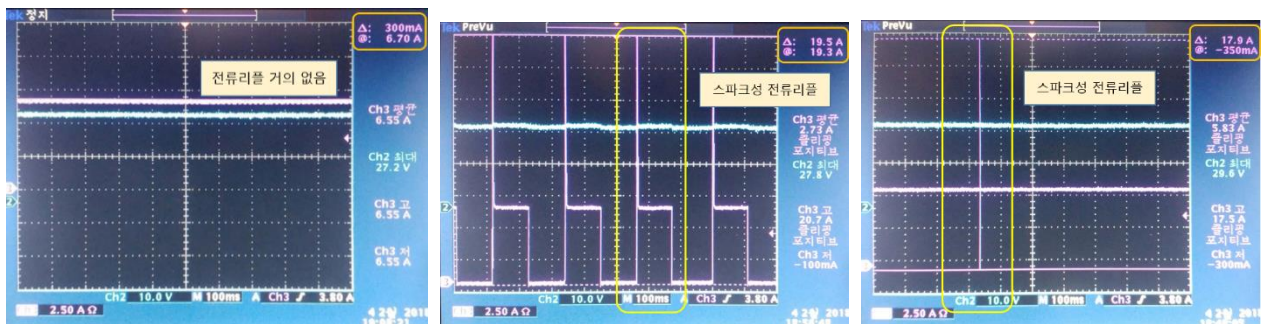
[ 타보스 태양광충전기 ] 전류 리플량( \Delta A ) = 0.3A
