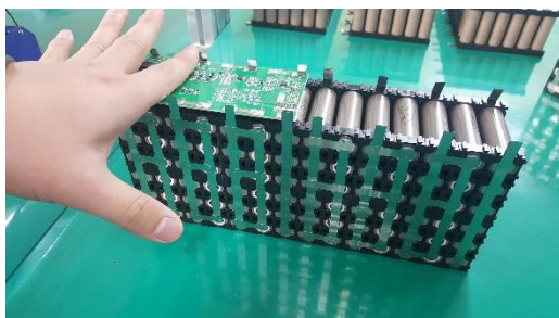
BMS 1 ( Battery Management Systems ) 보드 장착
