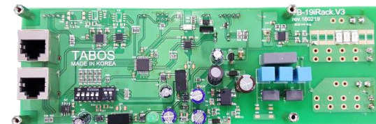
BMS 2 ( Battery Management Systems ) 보드 장착
