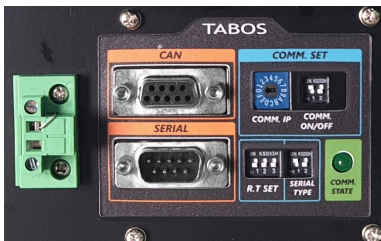
BMU (Battery Monitoring Unit) 통신 모듈
