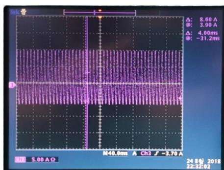
[ 좌측 사진 예시 : 인버터 배터리 전류 측정 ]
