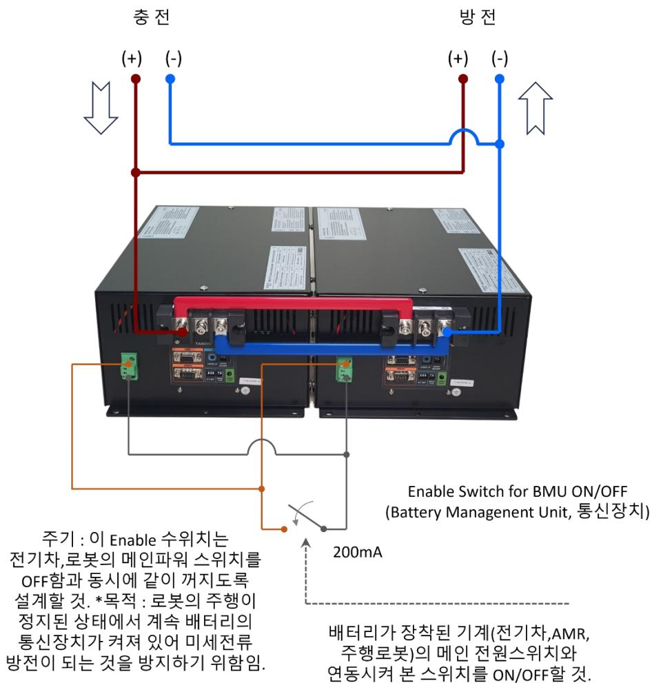
3)-6. 주의
