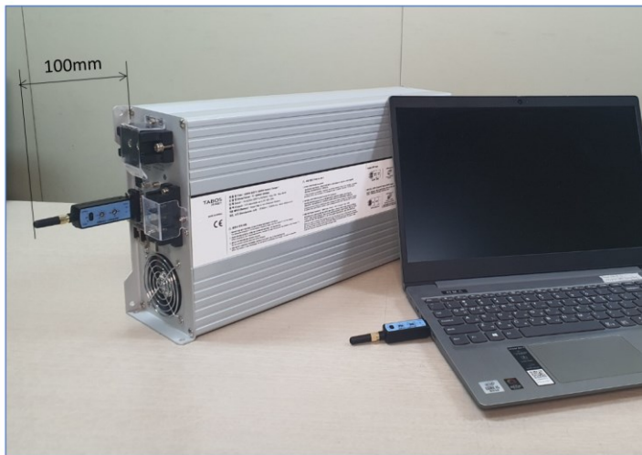
〈 그림 3500W 충전기 무선통신모듈 장착 공간 〉
