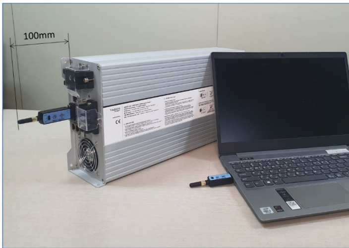
〈 그림 3500W 충전기 무선통신모듈 장착 공간 〉
