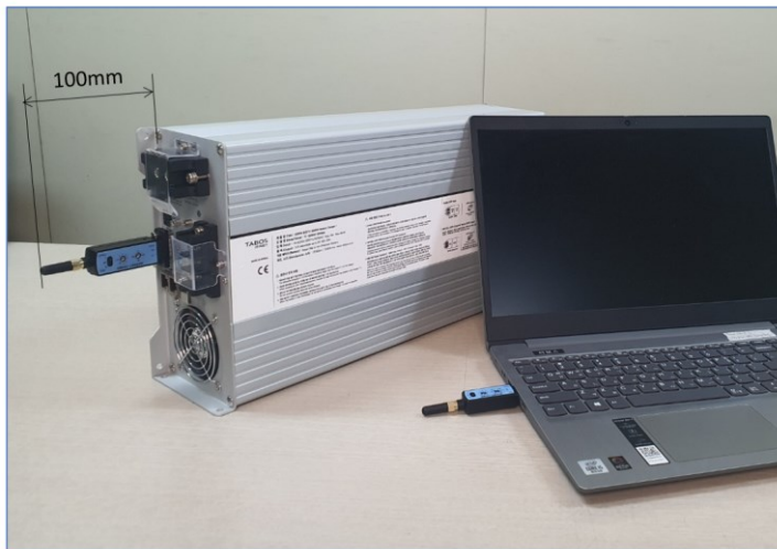
〈 그림 3500W 충전기 무선통신모듈 장착 공간 〉
