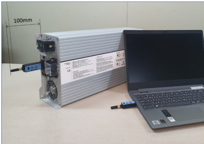
〈 그림 3500W 충전기 무선통신모듈 장착 공간 〉
