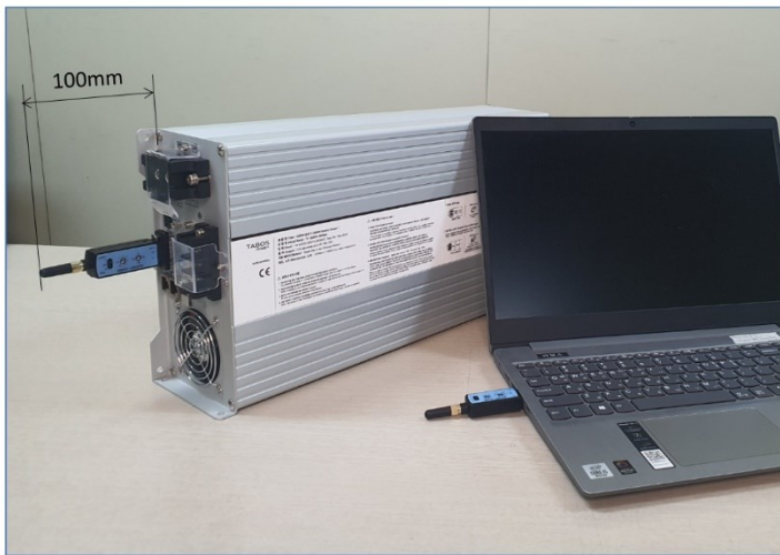
〈 그림 3500W 충전기 무선통신모듈 장착 공간 〉
