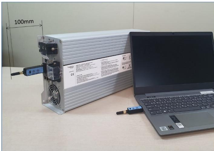
〈 그림 3500W 충전기 무선통신모듈 장착 공간 〉
