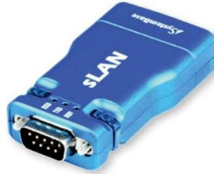
**주의 : 아래 그림과 같이 "sLANall"제품과 충전기본체의 D\_SUB 9Pin 코넥터의 핀맵이 서로 달라서 서로 맞추어 주는 어댑터 전선용치를 사용자가 직접 제작해야 합니다.**
