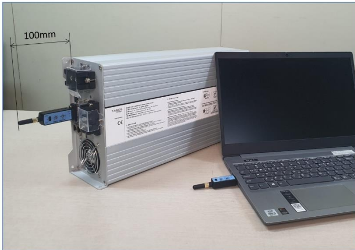
< 그림 3500W 충전기 무선통신모듈 장착 공간 >
