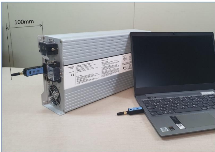
< 그림 3500W 충전기 무선통신모듈 장착 공간 >
