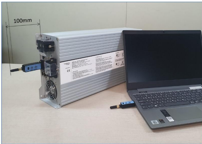
〈 그림 3500W 충전기 무선통신모듈 장착 공간 〉
