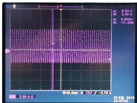
[ 좌측 사진 예시 : 인버터 배터리 전류 측정 ]
