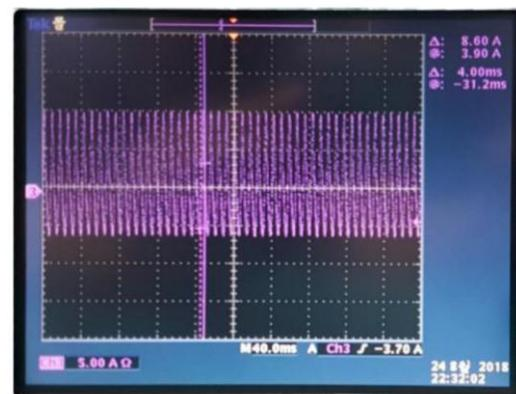
**우측 사진 / 시험결과** --> 1000VA 정현파 인버터를 부하전류 500W로 당길 때 배터리로부터 인버터로 공급되는 측정 전류는 8A였으며, 리플전류는 +10A, -10A 형태의 충격파(맥동파) 형태를 띠고 있음.
