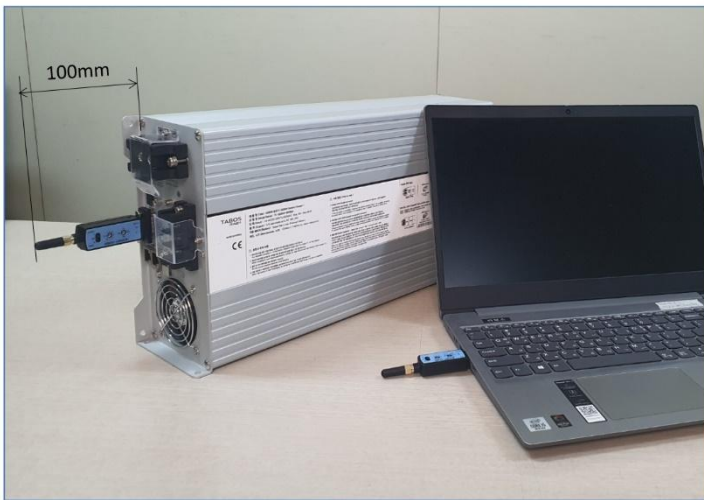
〈 그림 3500W 충전기 무선통신모듈 장착 공간 〉
