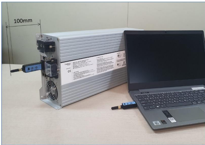
< 그림 3500W 충전기 무선통신모듈 장착 공간 >
